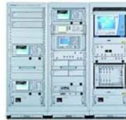
ME7873F позволяет выполнять проверки в соответствии со Спецификациями 3GPP TS34.121, включая тестирование передатчика, приёмника, производительности, RRM, HSPA и HSPA Evolution.
