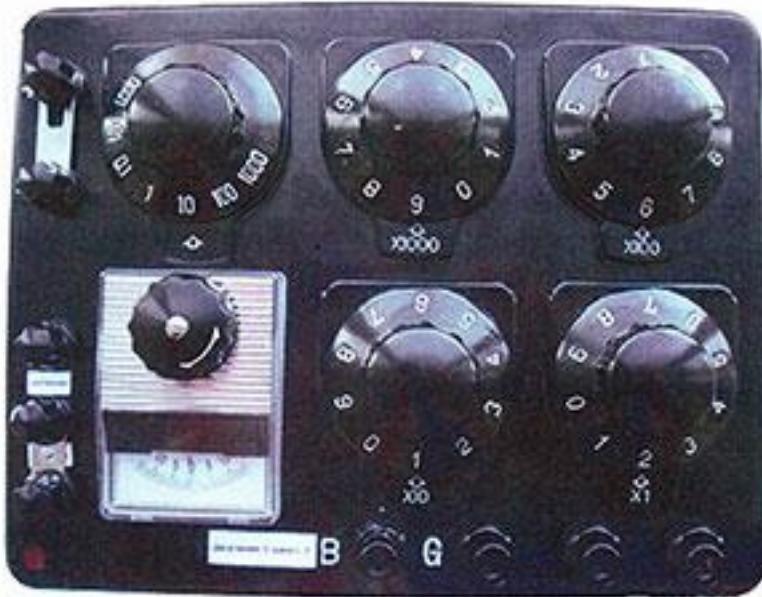
Рисунок 1 – Общий вид моста измерительного ПрофКип Р333-М1
