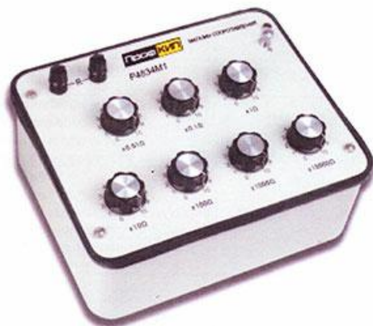
Рисунок 1 – Общий вид магазина сопротивлений
