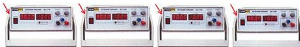
Рисунок 2 – Схема пломбировки от несанкционированного доступа.
