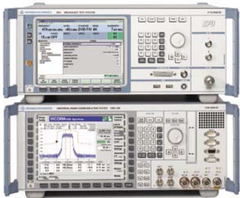
Тестирование широковещательной передачи на мобильные приемники с помощью R&S®SFU и R&S®CMU.
