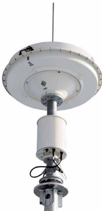
Рис. 5-2. Расположение пеленгаторных антенн на антенной мачте стационарного комплекса радиомониторинга и пеленгования. Антенна R&S® ADD070 снизу, R&S® ADD157 сверху
