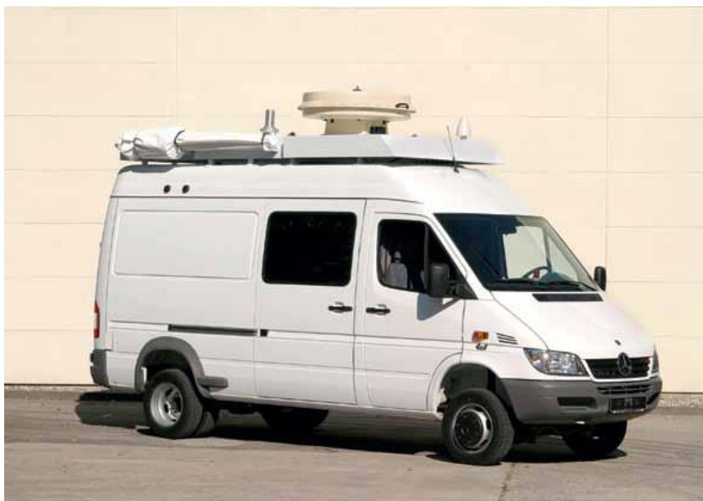
Рис. 5-1. Мобильный комплекс радиомониторинга и пеленгования. Антенна R&S®ADD295
