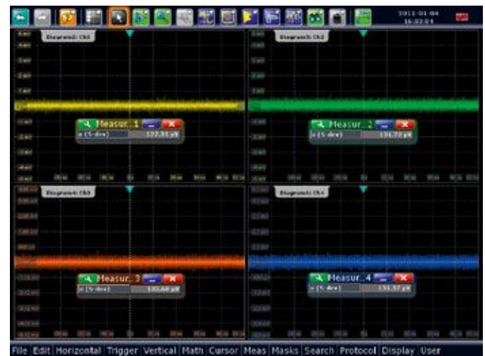
Рисунок 4 – Низкий уровень собственного шума даже при значении входной чувствительности по вертикали 1 мВ/деление.
