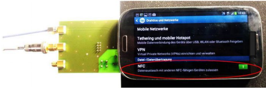
Рис. 3-1 – Размещение телефона с поддержкой NFC на эталонном устройстве приема для тестирования функции опроса (рекомендуется использовать сторону пайки эталонного устройства приема). В настройках телефона должна быть включена функция работы с NFC.
