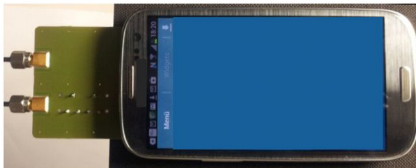
Рис. 4-7 – NFC-телефон для тестирования на эталонном устройстве опроса NFC
