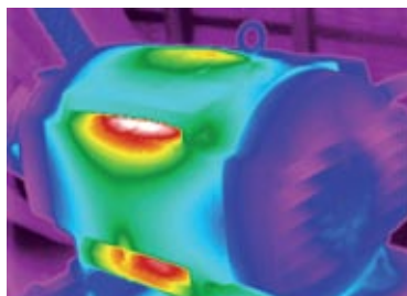
Аномальный неравномерный нагрев двигателя
