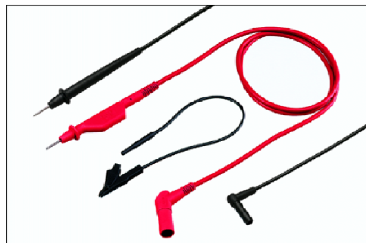
Рисунок 2. Измерительные провода STL120 (красный) и TL75 (черный) – основные инструменты для измерительных соединений к сети FOUNDATION Fieldbus. В случае сильных шумов в магистрали попробуйте использовать более короткий провод с зажимом типа "крокодил" (в центре). Все три компонента входят в стандартную поставку прибора Fluke 125 Scopemeter.
