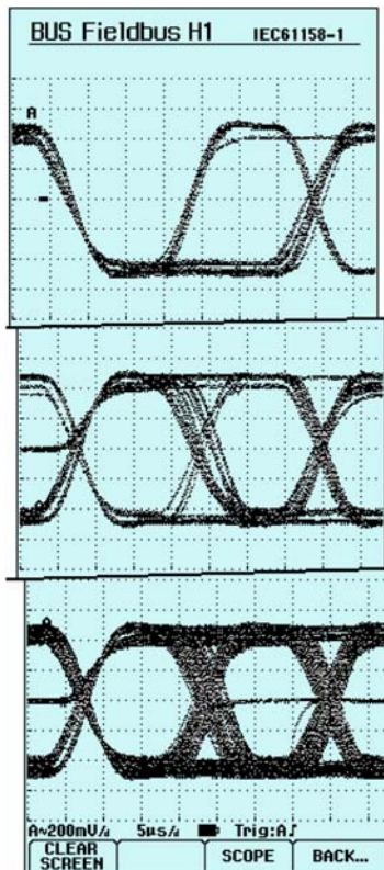
Рисунок 8. Этой серией экранов Fluke 125 показывается, как создается форма сигналов на экране при их последовательной фиксации с помощью режима глазоковой индикации прибором.
